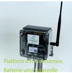
Plattform mit Lichtsensor, Batterie und Solarzelle
